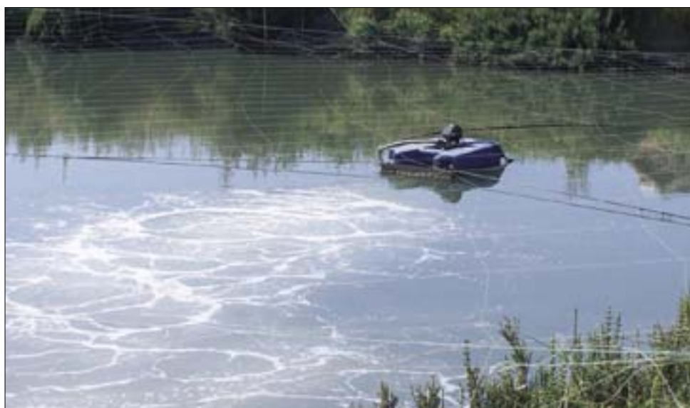
Ci-dessus : AÉROPULSE 2cv-380v, en fonctionnement sur un étang d'élevage de Daurades.
