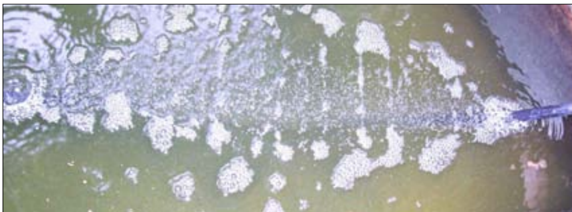
Tuyau diffuseur d'oxygène MICROBULL (démonstration dans un bac peu profond)
