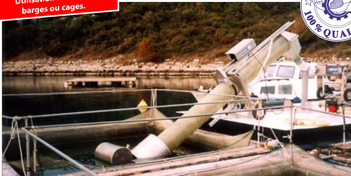
Élévateur série 77 ALU alimentant un trieur HELIOS 30S en bars et daurades, sur une barge cotière.
